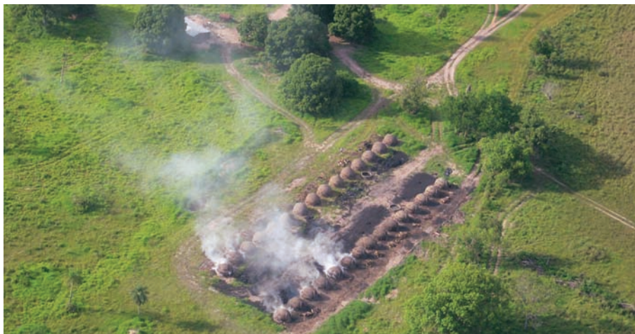
El carbón vegetal: el proceso más común en Brasil son hornos cilíndricos.
