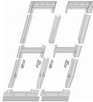
Figura 8.102 - Estrutura de montagem do sistema solar Roto
