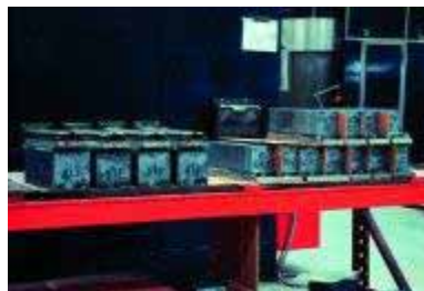
Figura 2.48 - Varetas de silício policristalino serrado Imagens: Photowatt
