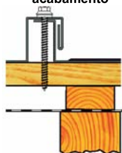
Figura 8.84 - Fixação visível usando parafusos de aço inoxidável e anilhas, e selagem EPDM
