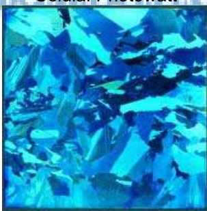
Figura 2.50 - Pastilha policristalina com uma camada de anti-reflexão Célula: Photowatt
