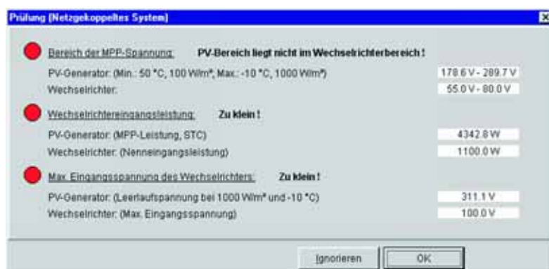
Figura 5.17 - Mensagem de erro do programa de simulação PVS devido a um incorrecto dimensionamento
