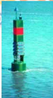
Figura 2.11 – Sistema fotovoltaico para o fornecimento de energia a bóias de sinalização marítima
