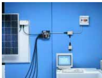
Figura 3.88 - Módulo AC com sistema de aquisição de dados operacionais e interface com um PC Fotografia: Dormmüller
