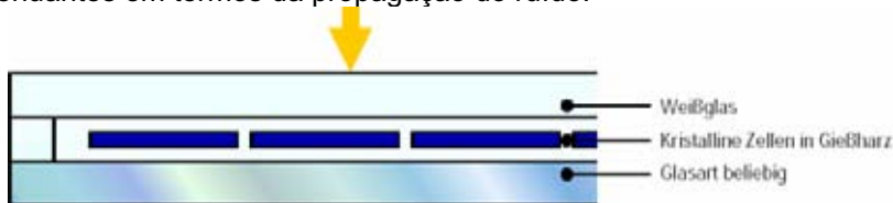
Figura 3.10 - Módulo vidro-vidro (resina fundida)
