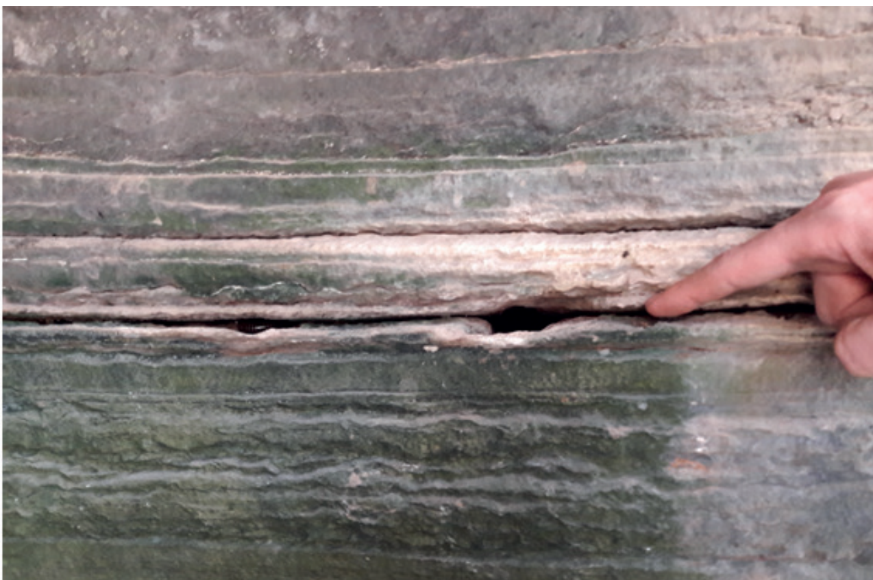
Figura 14 – Processo inicial de carstificação em rocha calcária em alargamento nos planos de acamamento da rocha (descontinuidades), por onde o fluxo de água acidificada circulou
